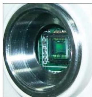
CHIP เปรียบเสมือนกล้องรับภาพ ทำหน้าที่เปลี่ยนสัญญาณแสงให้เป็นสัญญาณไฟฟ้า แบ่งได้ 2 ชนิด คือ
